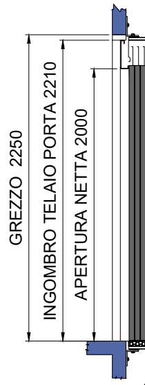
SEZIONE TELAIO PORTE MRF 120 (STANDARD ED EI 120)
