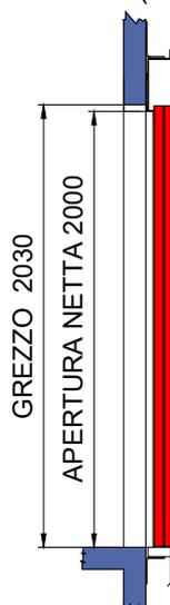
**SEZIONE VANO CORSA**
