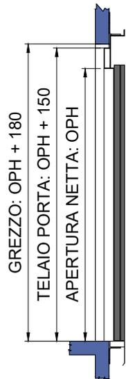
**SEZIONE VANO CORSA**
