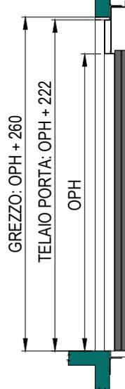
**SEZIONE VANO CORSA**
