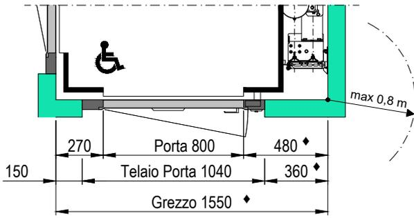
Viene fornito 0,8 m di cavo aggiuntivo per consentire il posizionamento del gruppo di manovra sul pianerottolo nel raggio di 0,8 m dalla posizione standard a cura del Cliente.
